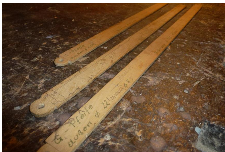
Abb. 4 Schablonen für verschiedene Stimmungen zum Einzeichnen der Position der Löcher.
