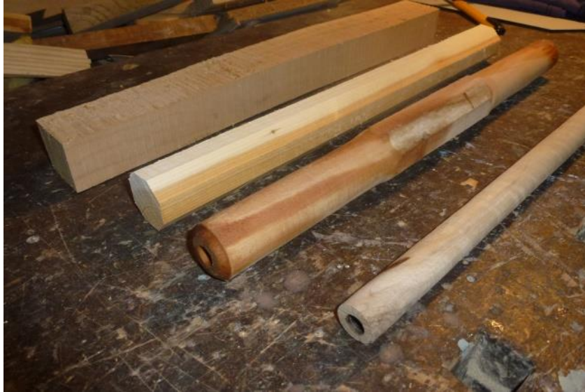
Abb. 2 Verschiedene Rohlinge (von hinten): vierkantig, achtkantig, grob überdrechselt (mit Innenbohrung), finer überdrechselt;
